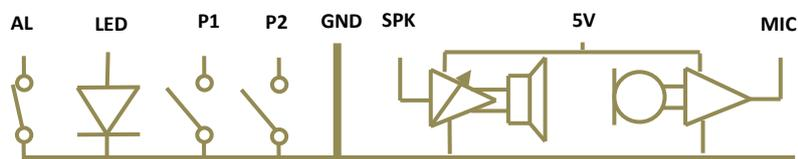
Los cuatro contactos que se accionan al accionar los botones están referenciados a “GND” (común) del pulsador. Los contactos son secos (*libres de potencial*). La señal de alarma es normalmente cerrada, y se activa tanto al pulsar el botón de alarma como al soltar el conector. Las señales de control de iluminación son normalmente abiertas.
